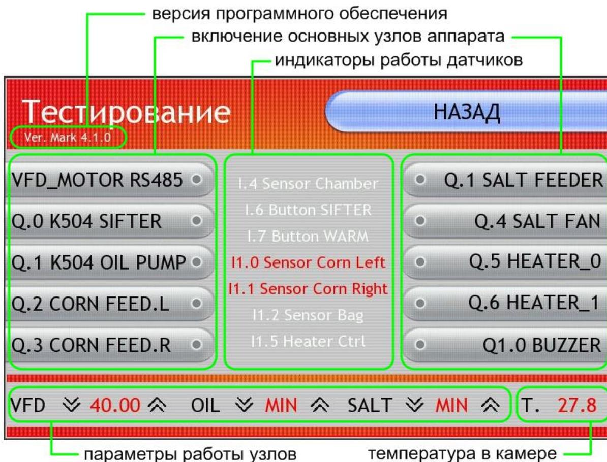
3. Запустите турбину мотора, нажав на панели кнопку VFD\_MOTOR RS485. Турбина начнет плавный разгон до минимальной рабочей частоты напряжения 40.00Гц. При помощи стрелочек регулировки установите частоту вращения 60.00Гц.
