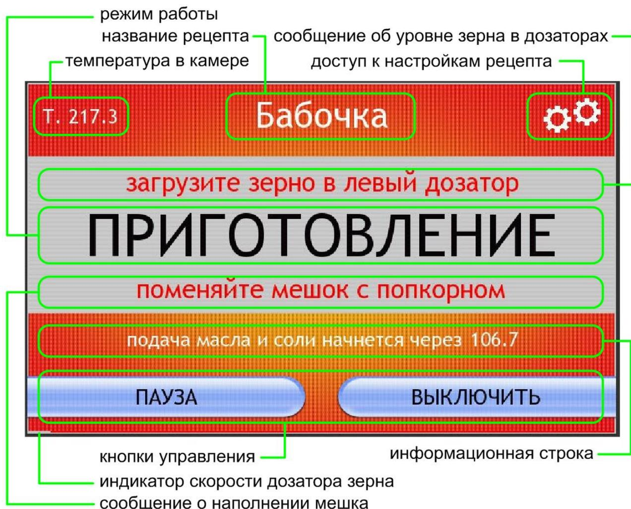
Подача зерна начитается с минимальной скорости, плавно увеличивая ее до максимальной, заданной в настройках (при достижении индикатором скорости правой границы экрана скорость дозатора максимальная). Время ускорения шнека дозатора зерна составляет 3,5 минуты. Первая партия зерна вылетает из камеры спустя 2 минуты.
