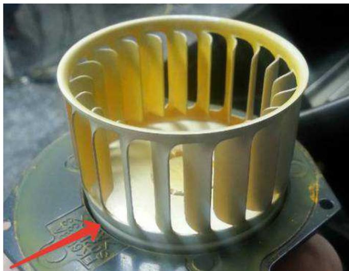
Продуйте крыльчатку вентилятора, удалив остатки соли между крыльчаткой и стенкой корпуса. Установите крыльчатку на место, после чего через тестовый режим запустите вентилятор.
